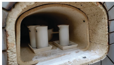
Рис. 4. Фарфоровые тигли с полученной смесью в печи
