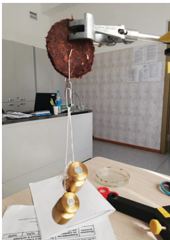
Рис. 6. Тестирование на прочность бананового пластика
