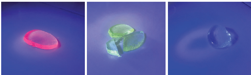
Рис. 5. Люминесценция образцов, содержащих ионы европия, тербия и тулия (слева направо)
