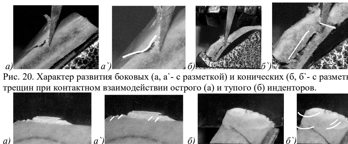
Рис. 19. Характер развития трещин при контактном взаимодействии острого (а) и тупого (б) инденторов.
