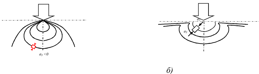
Рис. 16. Изобары вторых главных напряжений ( \sigma_2 ) при контактном взаимодействии острого (а) и тупого (б) инденторов.
