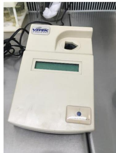
7. Извлечь пробирку из гнезда прибора. Через 1 минуту прибор автоматически выключится.
