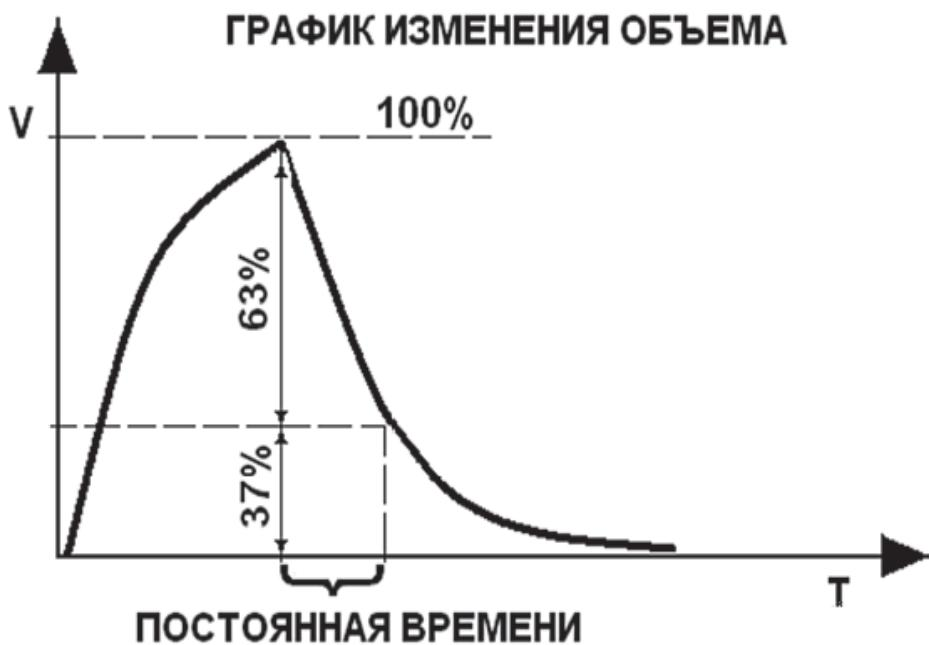
Данный график показывает, как современный аппарат ИВЛ рассчитывает постоянную времени. Бывает, что статический комплайнс рассчитать невозможно,
