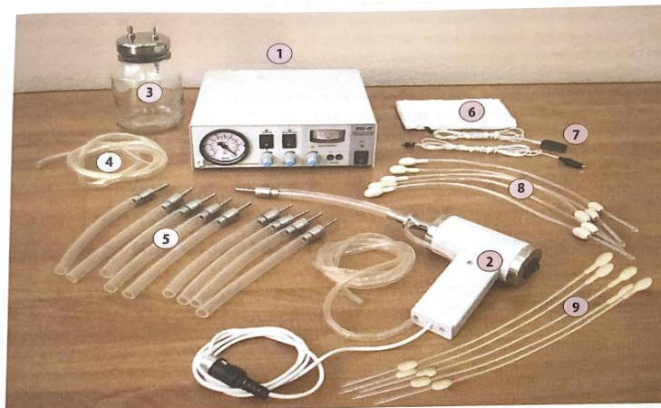
РИС. 8. Приставка «ВАЦ-01» к аппарату АМУС-01-«ИНТРАМАГ»: 1 — электронный блок приставки; 2 — пистолет вибратор-аспиратор; 3 — емкость для сбора аспирата; 4 — трубка; 5 — набор цервикальных наконечников с соединительными трубками; 6 — пассивный электрод для электрофореза; 7 — кабели для подключения электродов; 8, 9 — катетеры-ирригаторы электрофореза и орошения перед виброаспирацией
