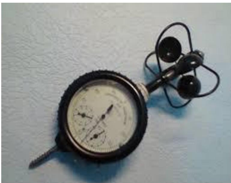
Рисунок 3 – Анемометр.
