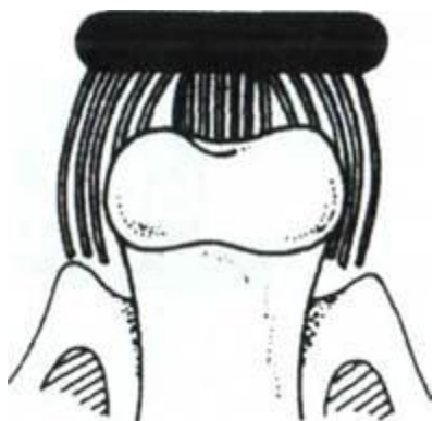
Рис. 3. Принцип очищающего действия зубной щетки с двухуровневой щетиной
