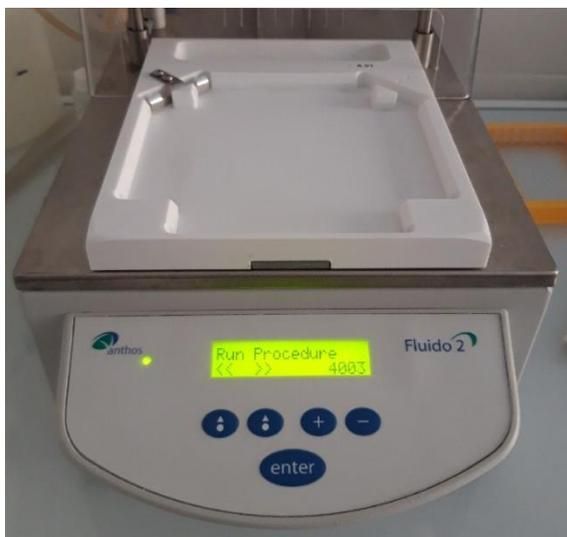
Автоматическое промывочное устройство (микропланшетный вошер) фирмы Anthos – Fluido упрощает и доводит до совершенства промывочную процедуру. Он может иметь 2 или 4 жидкостных канала и гребенки с 8, 12 и 16 парами иглок. Вошер программируется для автоматической промывки 96- или 384-луночных планшетов, можно юстировать
