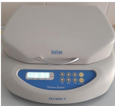
Термошейкер PST-60HL-4 предназначен для перемешивания стандартных 96 луночных планшетов в режиме термостатирования.
