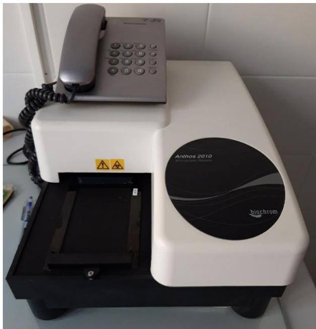
Anthos 2010 – это микропланшетный фотометр, предназначенный для использования в *in vitro* диагностике. Программное обеспечение ридера сочетает в себе гибкость, широкий спектр возможностей оценки теста и простоту использования. Фотометр 2010 комплектуется программой Adap plus, работает от обычного IBM-совместимого компьютера и/или интегрируется в лабораторную информационную систему.
