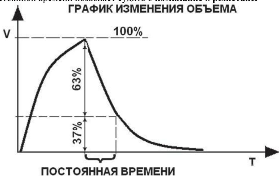
Данный график показывает, как современный аппарат ИВЛ рассчитывает постоянную времени. Бывает, что статический комплайнс рассчитать невозможно, т. к. для этого должна отсутствовать спонтанная дыхательная активность и необходимо измерить давление плато. Если разделить дыхательный объём на максимальное давление, получим еще один расчётный показатель, отражающий **комплайнс** и **резистанс**. Разные авторы используют разные имена, но мы должны знать, что это синонимы:
