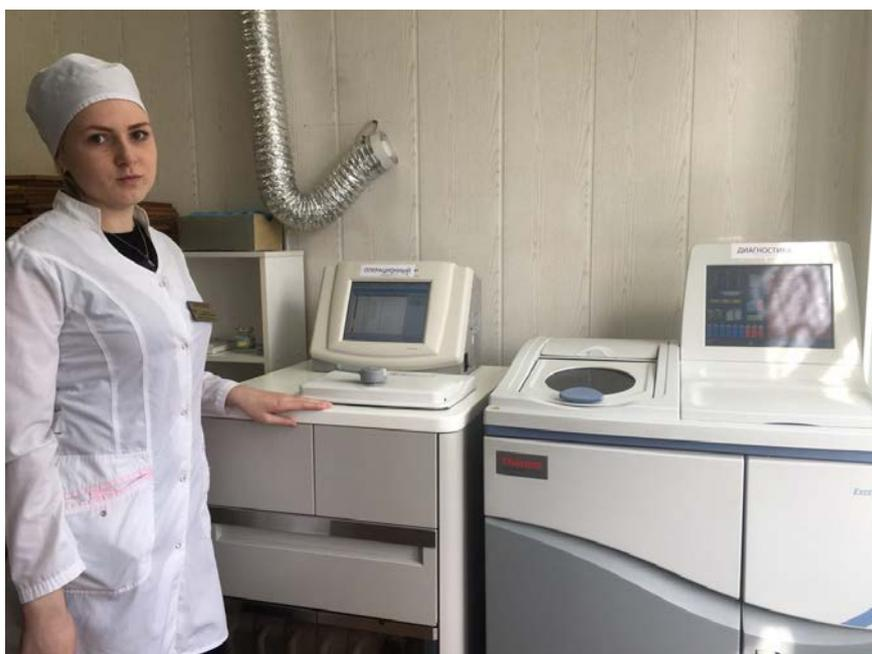
Рисунок 7 – Автоматическая заливочная станция мультистейнер Tissue-Tek Prisma
