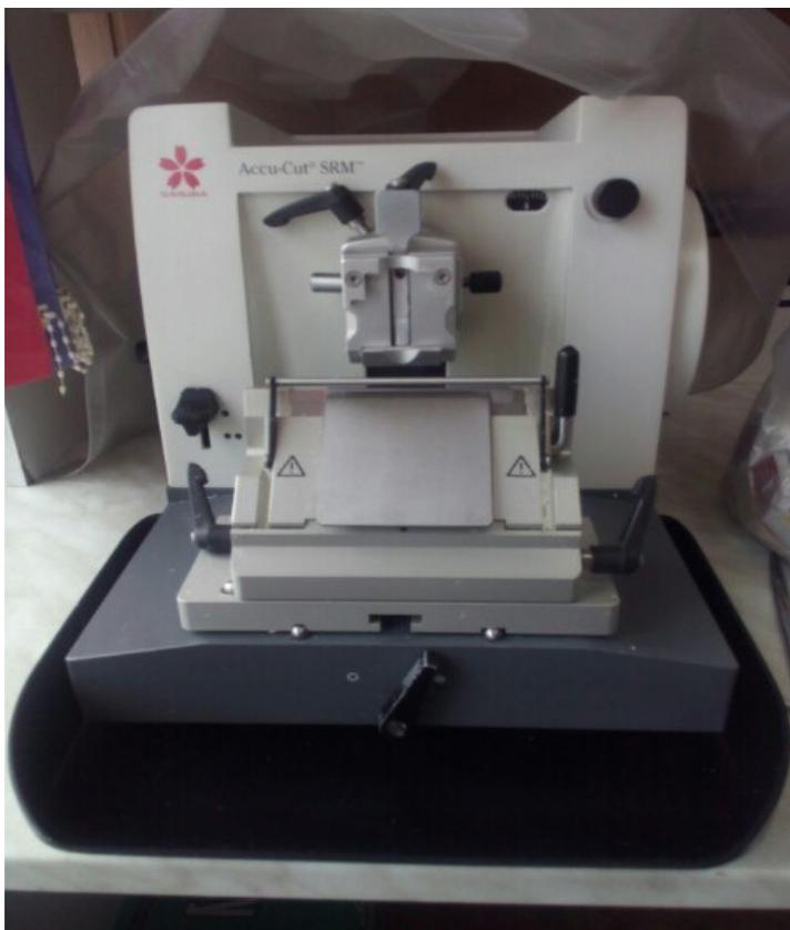
Рисунок 4 - Ротационный микротом
