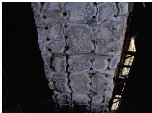
*Углеродный анод для производства алюминия: слева – вид сверху (в месте прикрепления токоподводящих штырей), справа – вид снизу (поверхность электрода, извлечённого из расплава для замены)*
