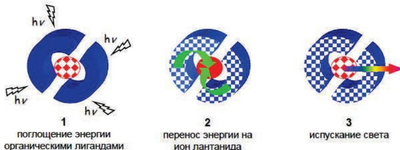
Рис. 3. Схема эффекта антенны
