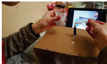
Рис. 5. Добавление сорбента в корпус ручки
